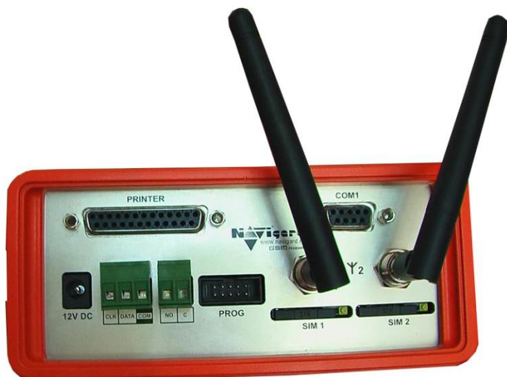
Рис. 8. GSM приемник NV DG 3220. Вид сзади.
